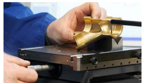
Prüfung mittels Konturograph
