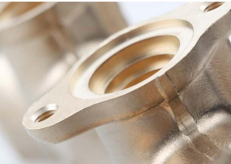
Durch Gesenkschmieden (Warmpressen) in unserer Warmpresserei werden bei auf den Werkstoff angepassten Schmiedetemperaturer Voll- und Hohlpressteile bis zu einem Stückgewicht von ca. 5.000 g hergestellt. Verarbeitet werden unterschiedliche Kupfer-Zink-Legierungen (Messing), entzinkungsarme sowie moderne, bleifreie Messinglegierungen nach UBA-Bewertungsgrundlage.
