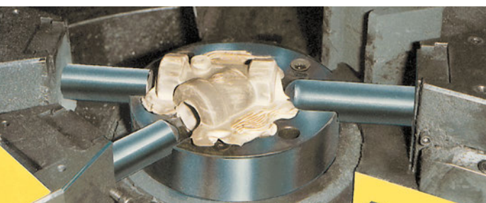
Minimierung des Einsatzgewichtes durch das Hohlpressverfahren
