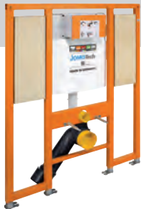
174-81100000-00 JOMOTech Einzellement für Wand-WC, mit Wandeinbau-Spülkasten SLK plus, für barrierefreies Bauen, mit 2 wasserfest verleimten Furnierholzplatten zur Aufnahme von Stütz- und Haltegriffen, Baubreite 880 mm, Bauhöhe 1120 mm
