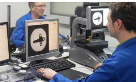
optische Vermessung mit digitalen Messprojektoren
