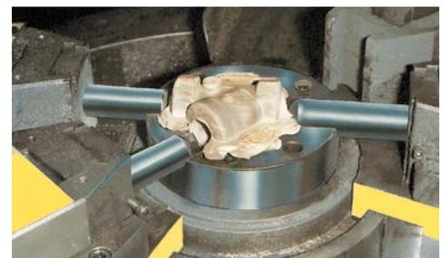
Minimierung des Einsatzgewichtes durch das Hohlpressverfahren
