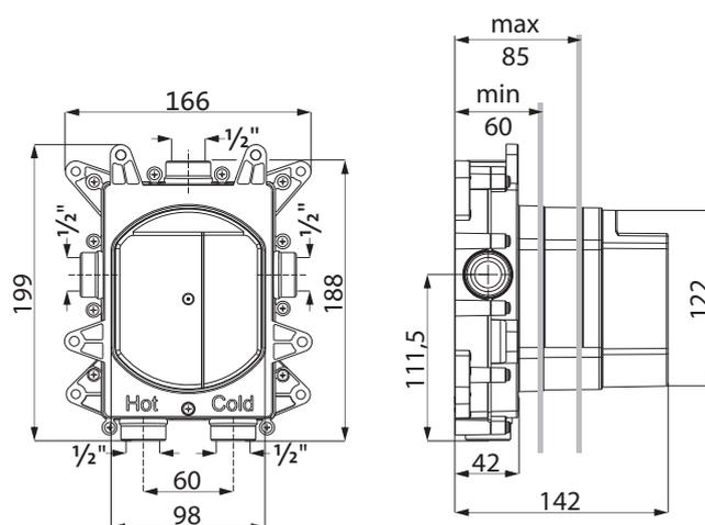
**LOGIC PLUS-Box Universal-Einbaukörper
